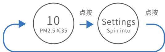
(1.1) 在PM2.5画面下，快旋进入风速显示页面，显示当前风机转速级别（“0”为不转，“32”为最高），然后再旋转可调节风速大小，若10秒后无操作则返回主菜单。
