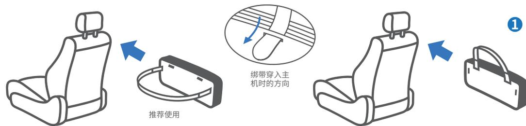
首先取出配件盒内的绑带,由内而外穿入主机安装孔并粘牢,可根据车座椅的形状选择将绑带穿入主机两侧或者上面的安装孔内,首选两侧。
