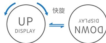
\* 将控制器USB接口调整至可方便使用方向，插入点烟器后，显示窗默认界面内容与可视方向相反时，可在DISPLAY模式下调整屏幕显示方向。
