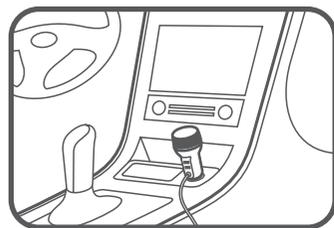
将控制器USB接口调整至可方便使用方向,再插入汽车点烟孔,发动车辆,当显示窗默认界面内容与可视方向相反时,可在菜单中调整显示方向。
