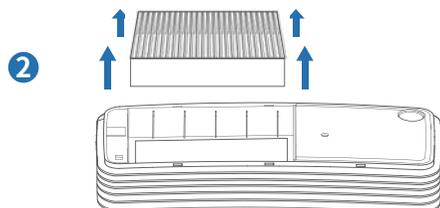
将车载净化器主机内的滤芯取出。
