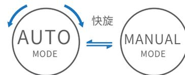
\* 在MANUAL（手动）工作模式下，风机速度由旋钮操作而定；
