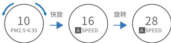
**注意：在“AUTO”（自动）状态下，手动调节风速后，风机会保持转速5分钟，5分钟后风机自动切回“AUTO”（自动）风速。**
