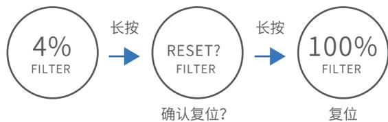
(2.4) 在Reset? (复位) 模式下, 长按 显示屏即可恢复出厂设置, 屏幕显示“Reset OK” (“复位成功”), 3秒后将自动返回至主菜单。
