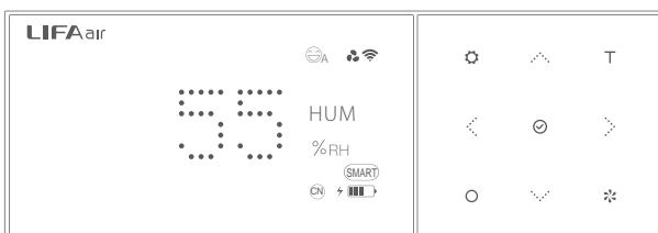
長按“T”，監控器會連續監測空氣質量並顯示5分鐘，副顯示屏閃爍“Test”標志，若要提前退出此模式，只需再長按“T”鍵。
