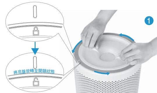
在地面鋪上一層毛巾或其他柔軟的防護墊，將主機翻轉，底部朝上，旋轉底盤解鎖（務必使DC電源斷電）。
