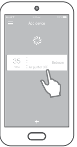
連網成功後，點擊連接到的監控器，輸入監控器密碼（MAC地址後六位，在監控器後部DC接口下面，不區分大小寫）
